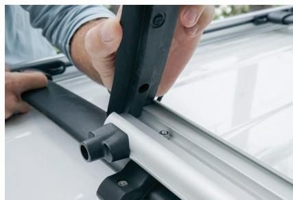
UNE FOIS QUE LA BASE EST SOLIDEMENT FIXÉE SUR LES BARRES DE TOIT, REMPLACEZ LA PROTECTION CAOUTCHOUC EN S'ASSURANT D'ALIGNER LES TROUS ET LES BOULONS.
