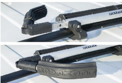
LORSQU'ILS NE SONT PAS UTILISÉS, LES BRAS PEUVENT ÊTRE ABAISSÉS POUR UNE ESTHÉTIQUE PLUS AÉRODYNAMIQUE. LORSQU'IL EST ABAISSÉ VERS LA GAUCHE LE BRAS EST VÉROUILLÉ ET NE SERA PAS EN MESURE DE SORTIR. LORSQU'IL EST ABAISSÉ VERS LA DROITE LE BRAS N'EST PAS VÉROUILLÉ ET IL PEUT FACILEMENT SORTIR DE SA RAINURE.
