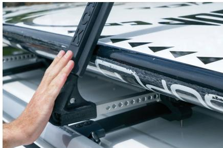
POSITIONNEZ CORRECTEMENT VOTRE MATÉRIEL (E.G, PLANCHE DE PADDLE, KAYAL...) SUR LE DISPOSITIF. DANS LA PLUPART DES CAS, LE MATÉRIEL DOIT ÊTRE INSTALLÉ À L'ENVERS. FAITES GLISSEZ LES BRAS VERS LA BASE JUSQU'À CE QU'ILS RENTRENT EN CONTACT AVEC VOTRE MATÉRIEL DES DEUX COTÉS.
