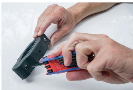
DESSERREZ LE BOULON AVEC UNE CLÉ HEXAGONALE DE TAILLE 5MM OU 3/16".
