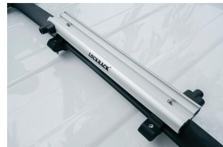
ATTACHEZ L'ADAPTATEUR AUX BARRES DE TOIT, NE PAS LE SERRER COMPLÈTEMENT PUIS ALIGNEZ LES TROUS DE VIS AVEC LA BASE. UNE FOIS DANS L'EMPLACEMENT DÉSIRÉ DES BARRES DE TOIT, SERREZ COMPLÈTEMENT JUSQU'À CE QU'IL N'Y AIT PLUS AUCUN JEU. PUIS PROCÉDEZ AU SERRAGE DES BOULONS SUR LES BARRES DE TOIT.
