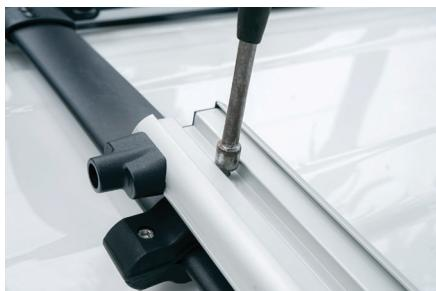
UNE FOIS QUE LA BASE EST CONVENABLEMENT POSITIONNÉE SUR LES BARRES DE TOIT, SERRER LES BOULONS À L'AIDE DE LA CLÉ 10MM FOURNIE.
